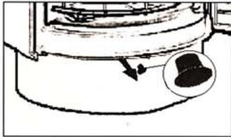
Bild 21: Herausziehen des Verschlusses des Tauwasserablaufs
